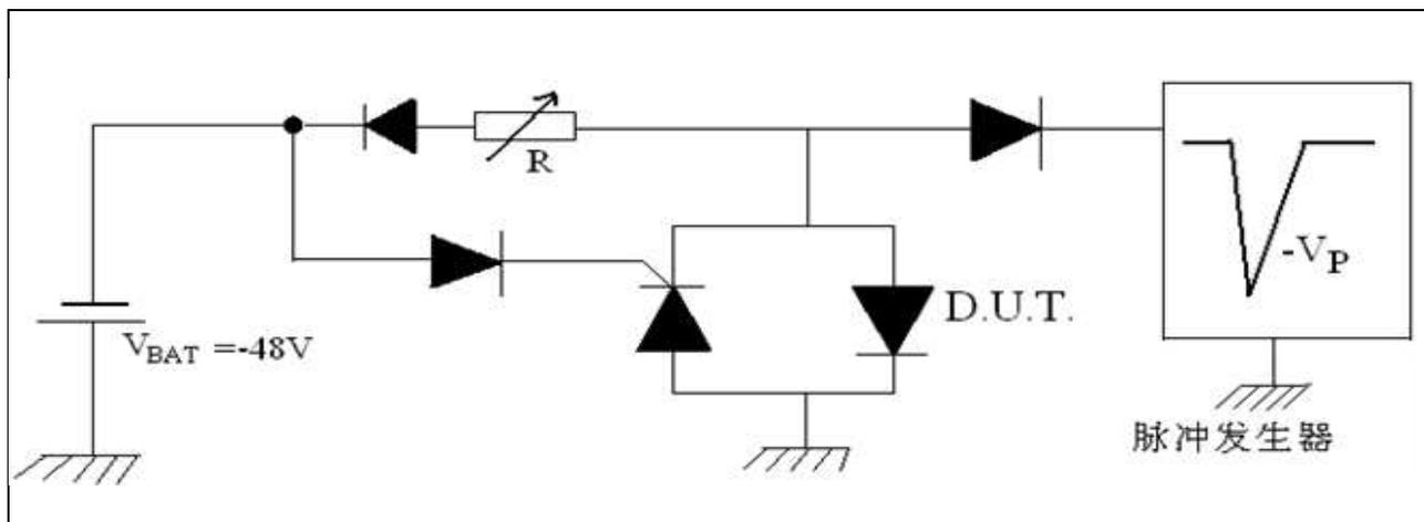
这是一个“导通-截止”测试，该测试电路可以确定维持电流的大小。
